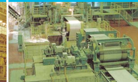
출축 설비는 검사대, Oiler, 권취 설비로 구성되어 있으며 고객사가 원하는 제품으로 적합한지 종합적으로 검사하고 판정한다.
